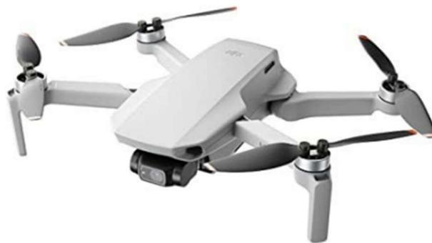
Il s'agit d'un drone ultra léger de 249 grammes équipé d'une caméra de 1/2,3 pouces capable de faire des vidéos en 4K 30 Hertz. Ce drone est parfait pour débuter, il possède de nombreuses aides au vol : stabilisation automatique du drone, retour au point de décollage en cas de perte de liaison entre la radiocommande et le drone, suivi en direct de l'état de la batterie (autonomie restante, température, tension).
